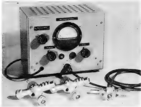
Bild 1. Dezimeter-Leistungsmesser für das 3-cm-Band mit einem auf 1 bis 2 Watt erweiterungsfähigen Meßbereich von 10 mW (Werkbild Telefunken)
