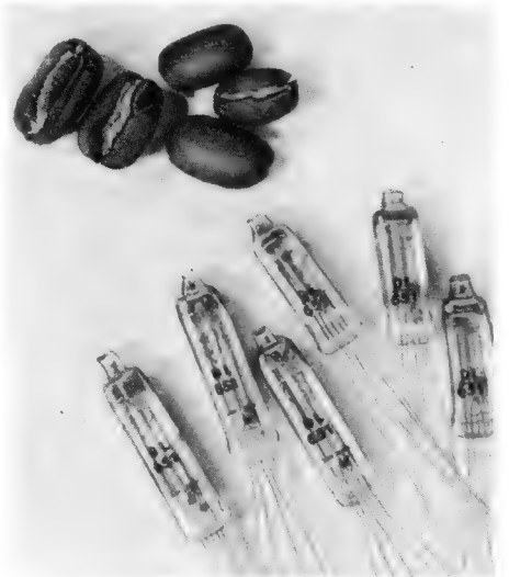
Bild 1. Telefunken-Subminiaturröhren DF 651 und DL 651 im Größenvergleich zu Kaffeebohnen
