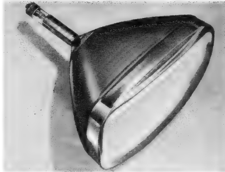
Bild 2. Amerikanische Bildröhre mit verkürzter Baulänge
