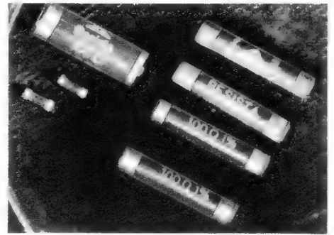
Bild 2. Spezialwiderstände für UKW und Dezi-technik mit versilberten Lötanschlüssen zum direkten Einfügen in den Leitungszug. (Natürliche Größe der Kleinstausführung 1 \times 4 \text{ mm} )
